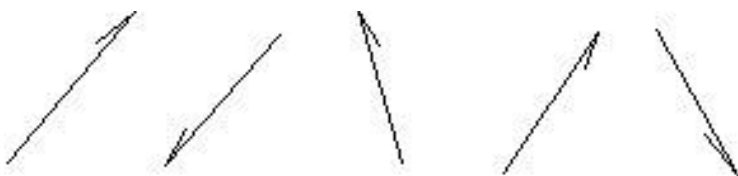
Рис. 4.28. Обозначение швов линиями-выносками без полок
