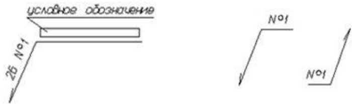
Рис. 4.27. Обозначение одинаковых сварных швов на чертеже
